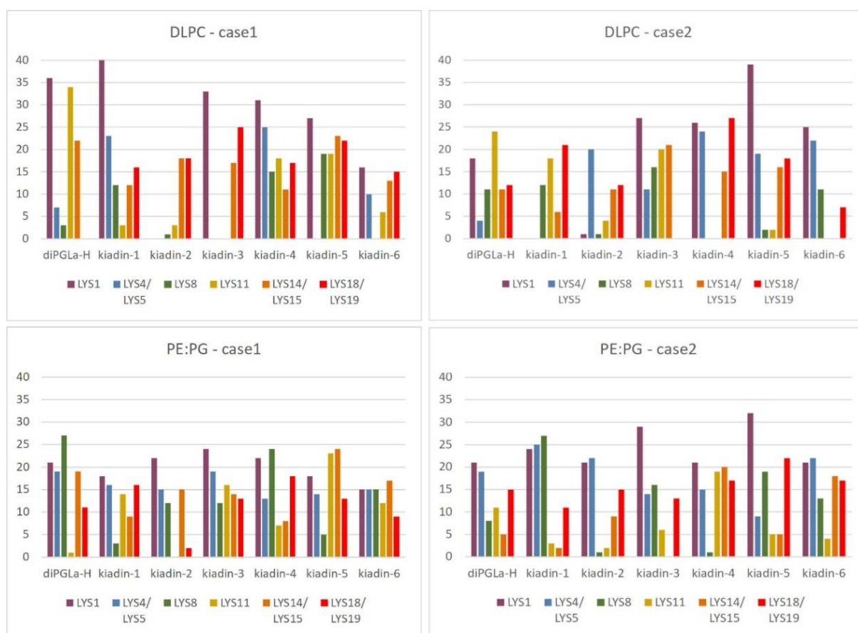
Slika 49 Prosječan broj kontakata između pojedinačnih atoma lizina i membranskih fosfatnih atoma usrednjeno tijekom zadnjih 100 ns simulacije određen Gromacsovim programom mindist . Korištena je granična udaljenost za kontakte od 0.6 nm. Svaki kontakt između atoma bilo kojeg atoma lizina i bilo kojeg P atoma membrane računa se kao jedan. Prikazani su rezultati za case1 i case2 za oba tipa membrane. Lizini su označeni različitim bojama naznačenim ispod histograma.
