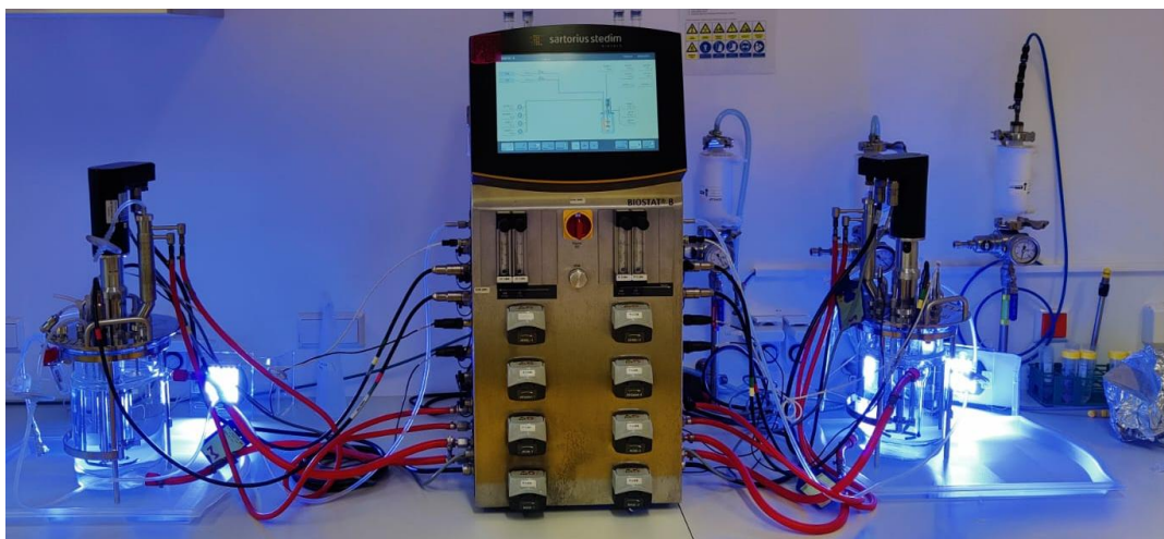
Slika 2. Laboratorijski uzgoj dijatomeje Skeletonema grevillei u bioreaktoru s LED svjetlom (vlastita fotografija)
