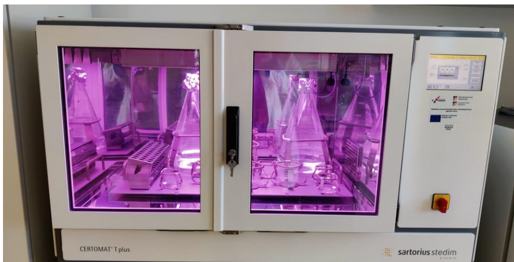
Slika 1. Laboratorijski uzgoj dijatomeje Skeletonema grevillei u inkubatorima s integriranim sustavom miješanja (vlastita fotografija)
